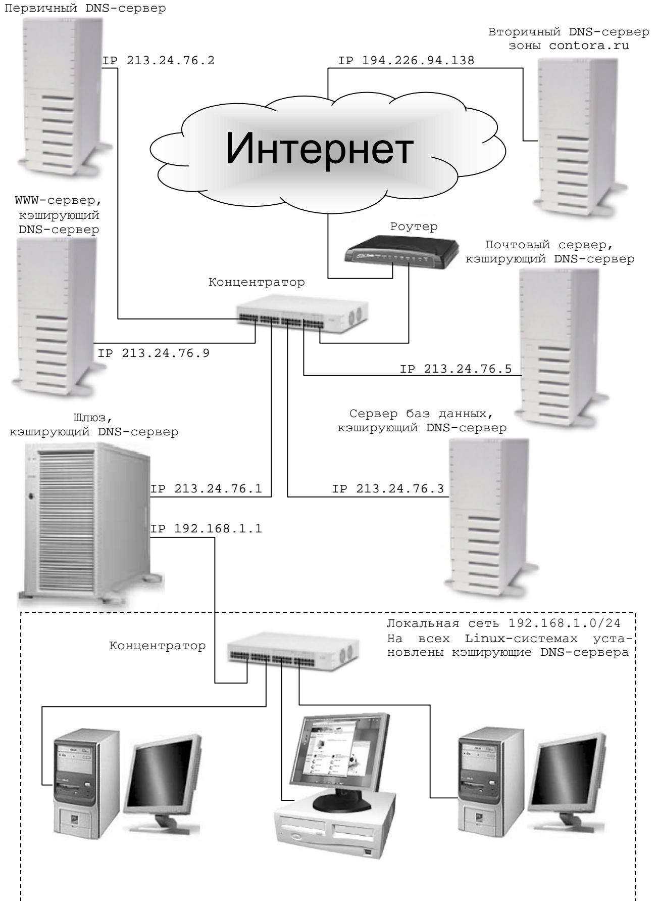
Рис. 23.1 Принципиальная схема организации службы DNS.
